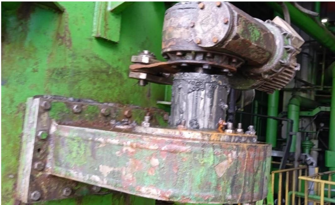
**Figura 4:** Motor y reductor del filtro
