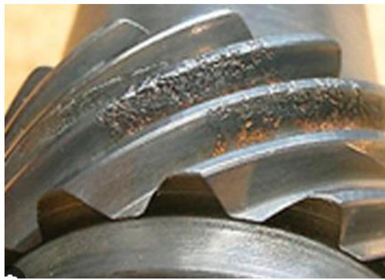
**Figura 1.9:** Fatiga en la superficie de los dientes de un engranaje
