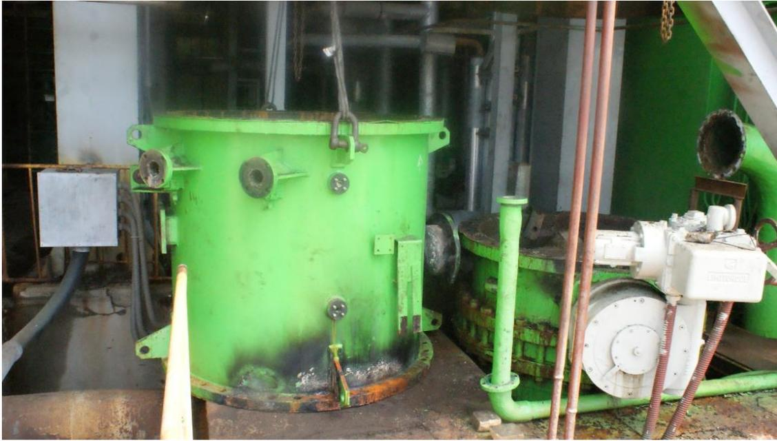
**Figura 3:** Filtro desmontado
