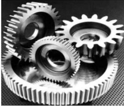
**Figura 1.3:** Engranajes cilíndricos de dientes rectos
