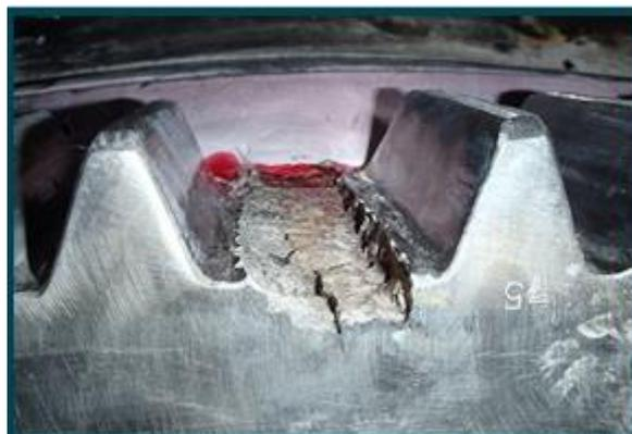
**Figura 1.7:** Rotura del diente de un engranaje
