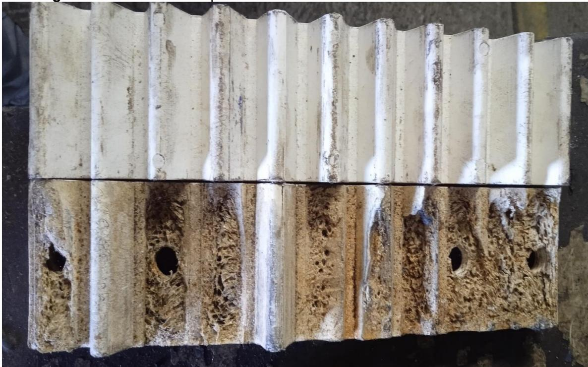
**Figura 6:** Vista superior comparación de sector dentado nuevo con sector dañado
