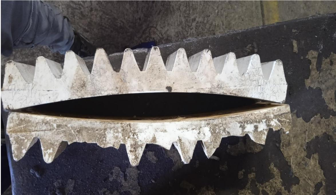
**Figura 5:** Vista lateral comparación de sector dentado nuevo con sector dañado
