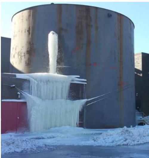
Figura 9: Fallo por corrosión
