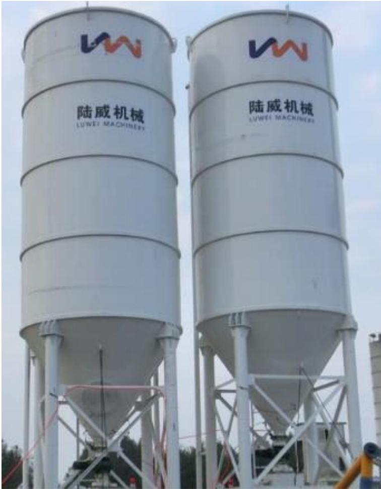
Figura 2: Depósito cilíndrico vertical, fondo cónico y techo plano
