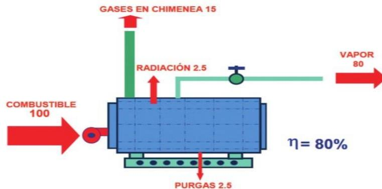
Las pérdidas de calor en la superficie exterior de la caldera se producen de dos maneras diferentes, en forma de radiación y convección. La pérdida de calor causada por la convección es directamente proporcional a la temperatura de la pared, y la pérdida de calor por radiación es directamente proporcional a la cuarta potencia de estas temperaturas (Durukafa D. Quinto Congreso de Eficiencia Energética, Kocaeli, Turquía, 2019).
