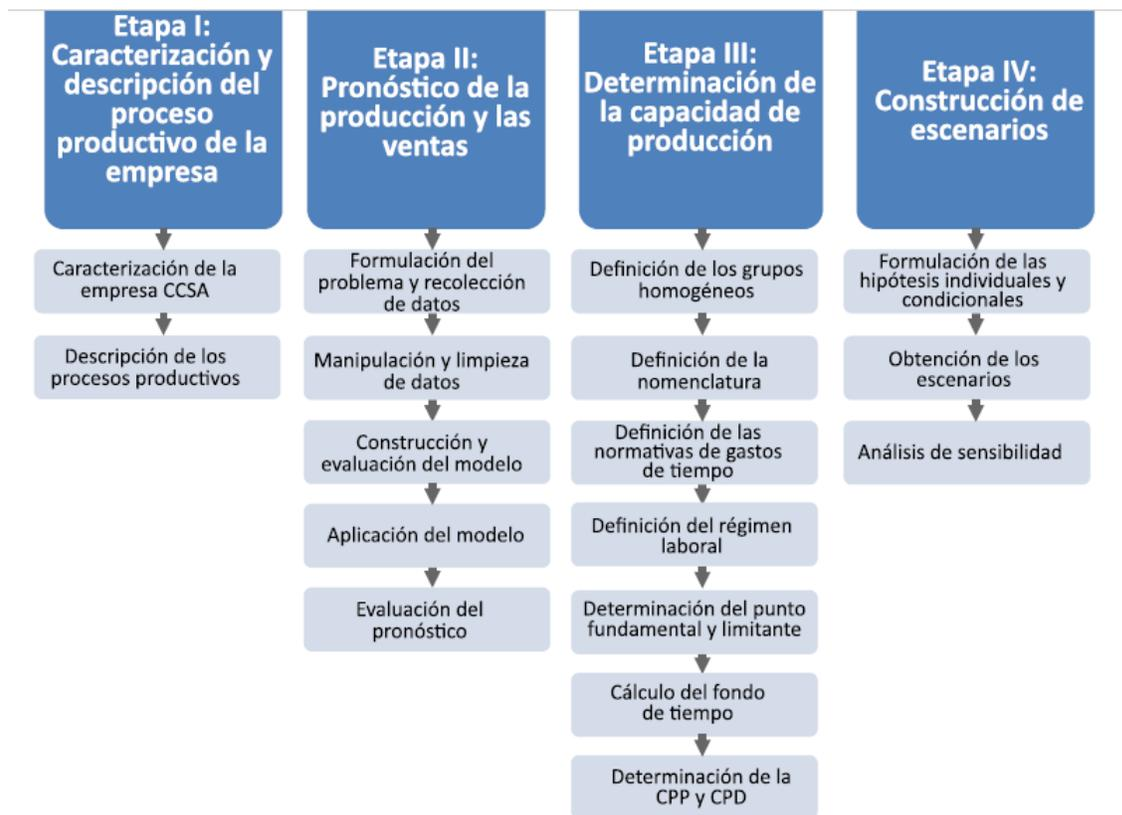
Figura 2.4: Procedimiento para la determinación de la capacidad de producción en la empresa Cementos Cienfuegos S.A.
