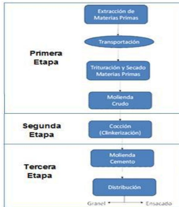
Figura 2.1: Diagrama de primer nivel del proceso productivo.
