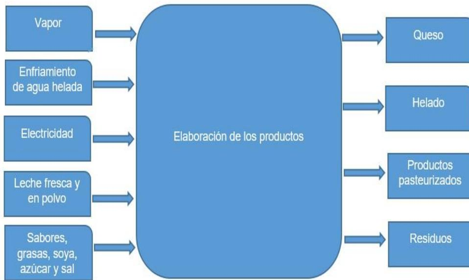
Figura. 2.1: Diagrama energético producción de la EPLE
