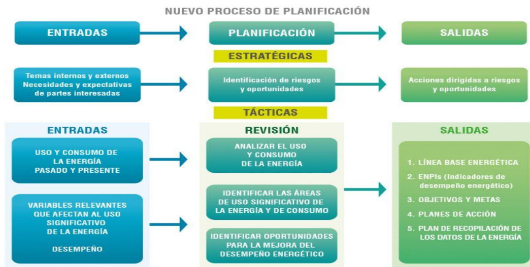
Figura 1.10: Proceso de planificación energética ampliado. Fuente: AENOR
