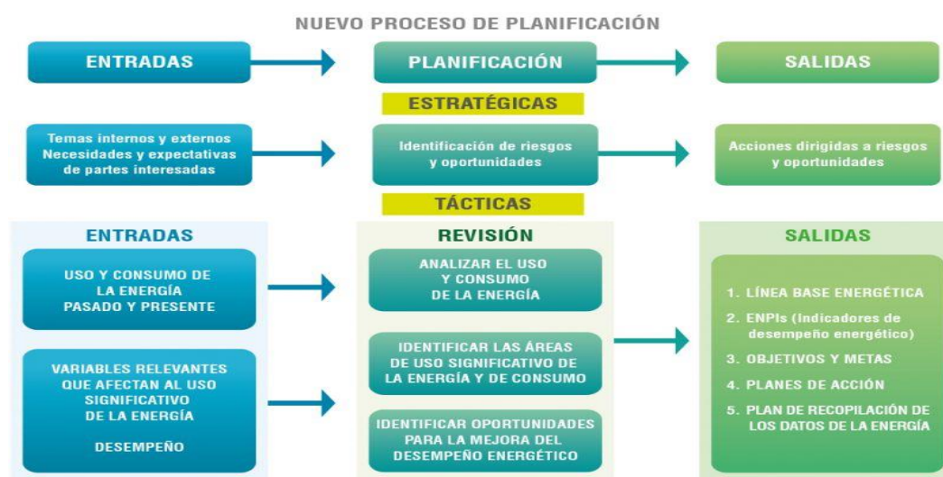
Figura 1.10: Proceso de planificación energética ampliado. Fuente: AENOR
