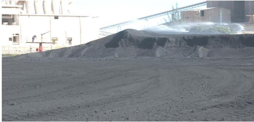
Fig.2.12 Rociado de las pilas. Fuente: (Cementos Cienfuegos S.A, 2010)
