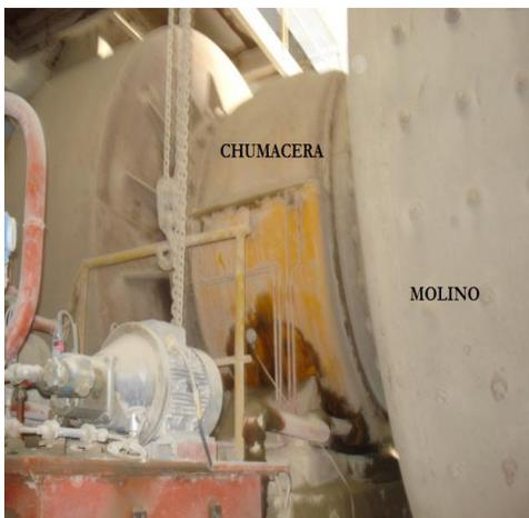
Fig.2.6. Chumacera del Molino de Crudo. Fuente: (Cementos Cienfuegos S.A, 2010)
