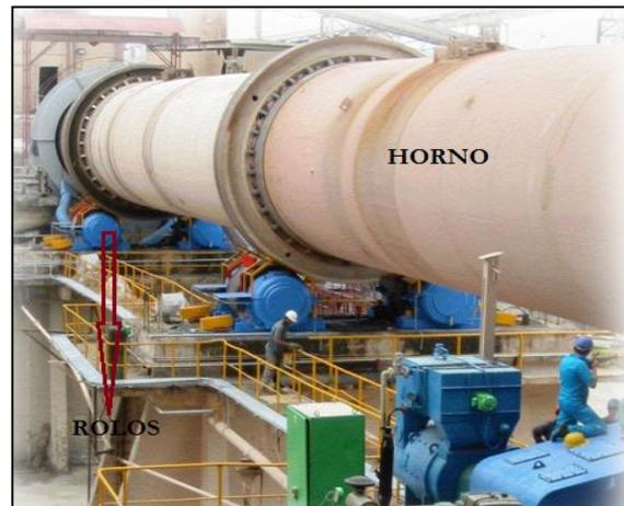
Fig. 2.10. Sistema de enfriamiento de los rolos del Horno. Fuente: (Cementos Cienfuegos S.A, 2010)
