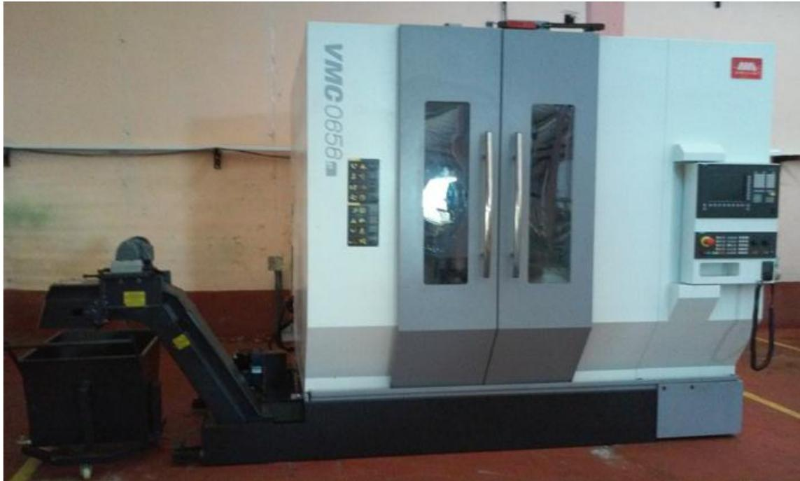
**CENTRO MECANIZADO 5 EJES INTERPOLADOS**
