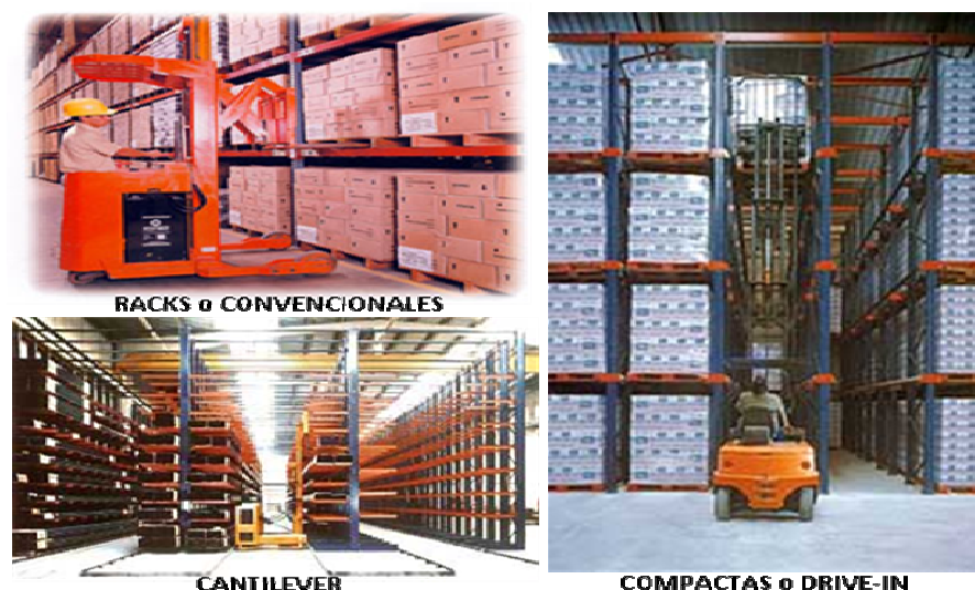
Figura 2.16: Tipos de Estanterías que se incluyen en el análisis. Fuente: Brito Brito, A. (2005).
