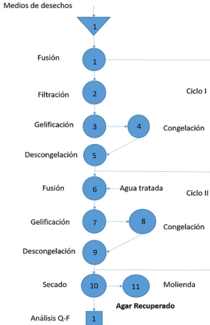
**Figura 3.2:** Diagrama de flujo de la recuperación de agar-agar. **Fuente:** Elaboración propia.
