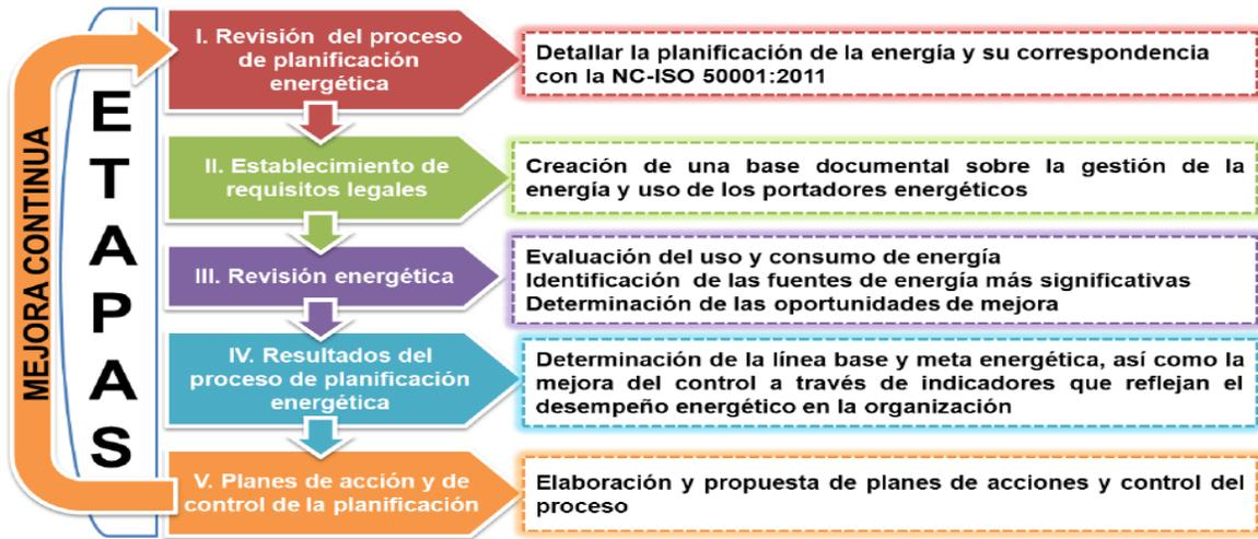
Figura 2.3: Resumen del procedimiento para la planificación energética.
