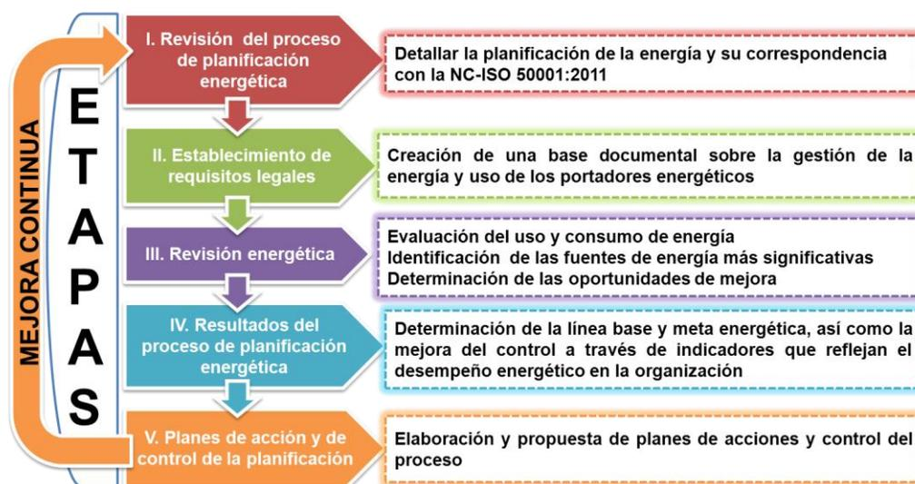
**Figura 2.5** Resumen del procedimiento para la planificación energética.
