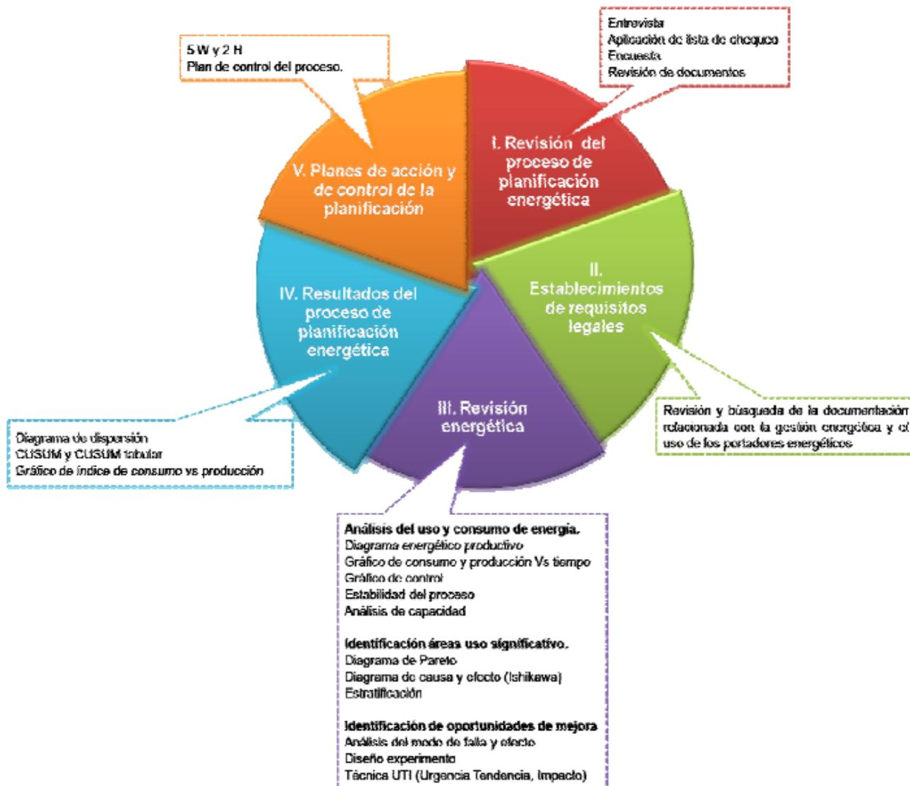
Figura 2.11: Procedimiento para la planificación energética. Fuente: (Alpha Bah, 2013.)
