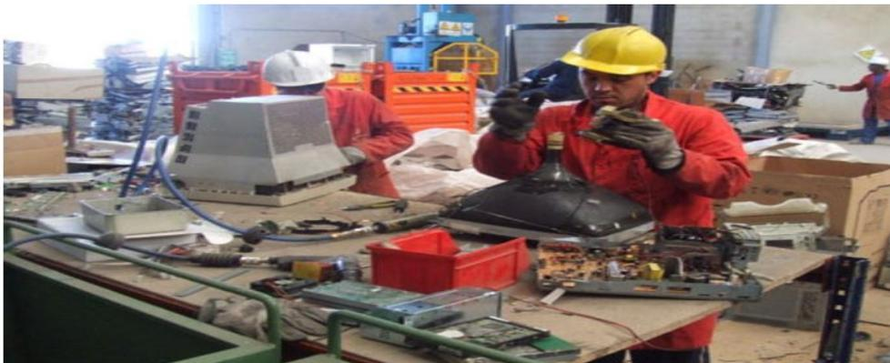
**Figura 3.1.-** Desensamblado y separado de componentes de los TRC. **Fuente:** Proyecto Ecovitrum 2013.
