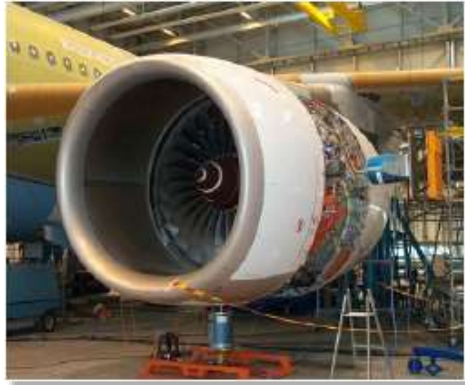
Figura 1.7. Distribución por posición fija: ensamblaje de un avión Airbus A340/600 en la planta de Airbus en Toulouse (Francia) Fuente: (Mas, 2010)
