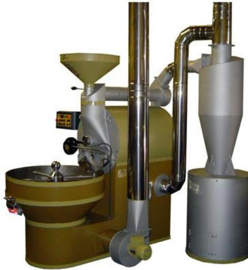
**Figura 1.10:** Tostadora con recirculación del aire del tostado del café. (DISCAF 2011). Estas tostadoras reutilizan una parte importante de los gases de combustión, mejoran su rendimiento y propician un significativo ahorro de energía y reducen en gran medida la aportación de humo a la atmósfera. Sin embargo, un Oxidador Termal separado es la práctica recomendada, pues con éste se alcanzan las temperaturas deseadas.
