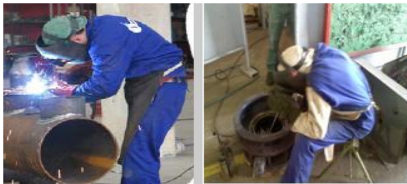
Figura 3.18: Postura adoptada por el trabajador en la conformación de tuberías antes y después de la mejora realizada. Fuente: Elaboración propia
