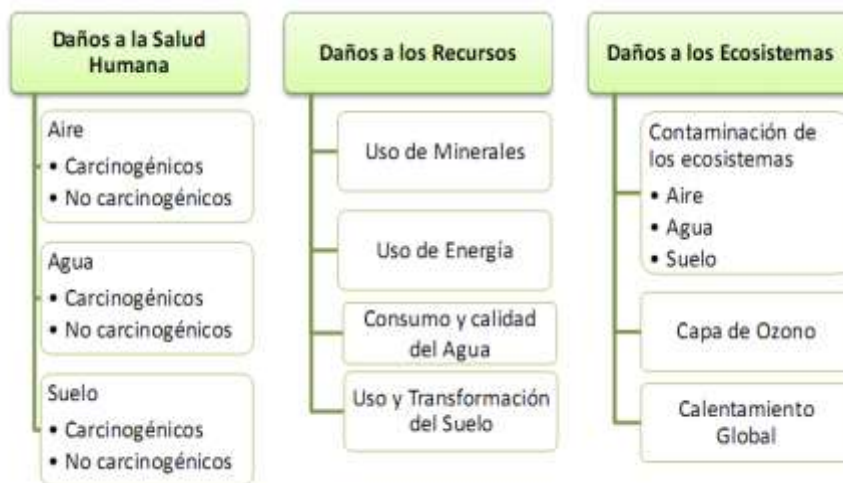
Figura 1.9: Categorías de Impacto y Daño en Eco-Speed. Fuente: Fernández Rodríguez, 2012.
