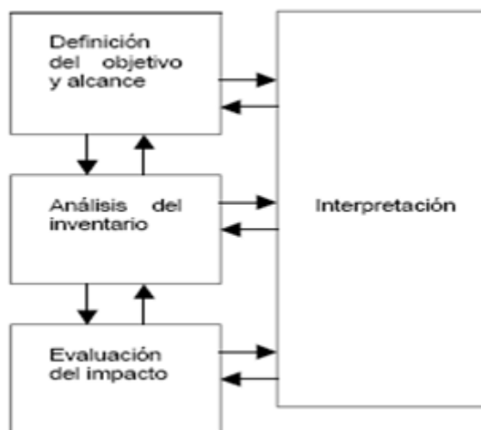
Figura 1.7. Fases de un ACV de un producto en general. Fuente: (Romero, 2004)
