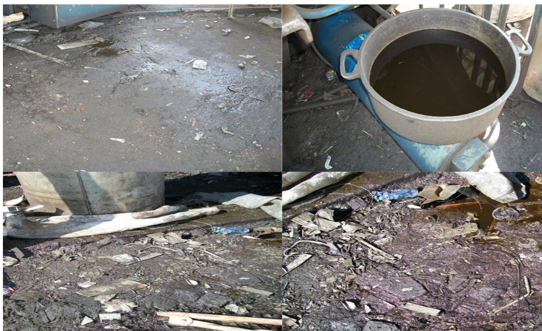
Figura 3.6. Salideros de aceite y desechos metálicos en “prensado de Aluminio” (No ferroso).
