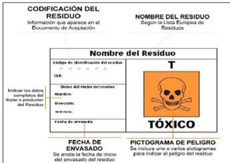
Figura 2.9. Ejemplo de como etiquetar los residuos peligrosos.
