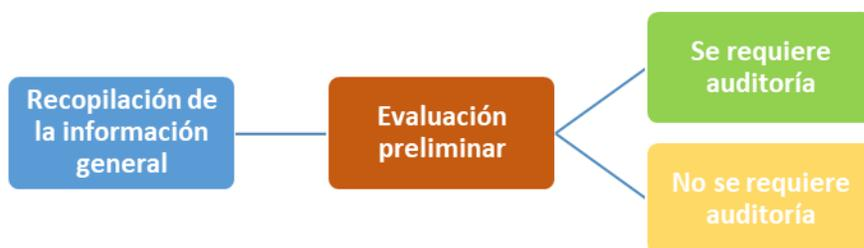
*Figura 2. Partes componentes del paso de la planificación de la auditoría energética.*
