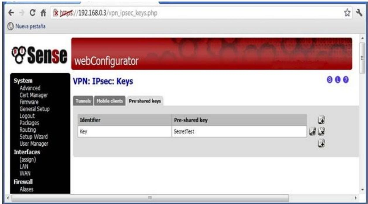
Figura 45. Configuración del servidor VPN IPsec en PfSense (parte 5).
