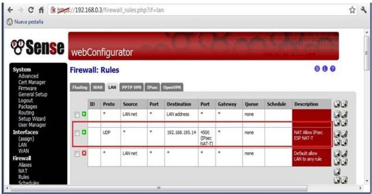
Figura 48. Regla en el Firewall de PfSense para la VPN IPsec (interfaz LAN).
