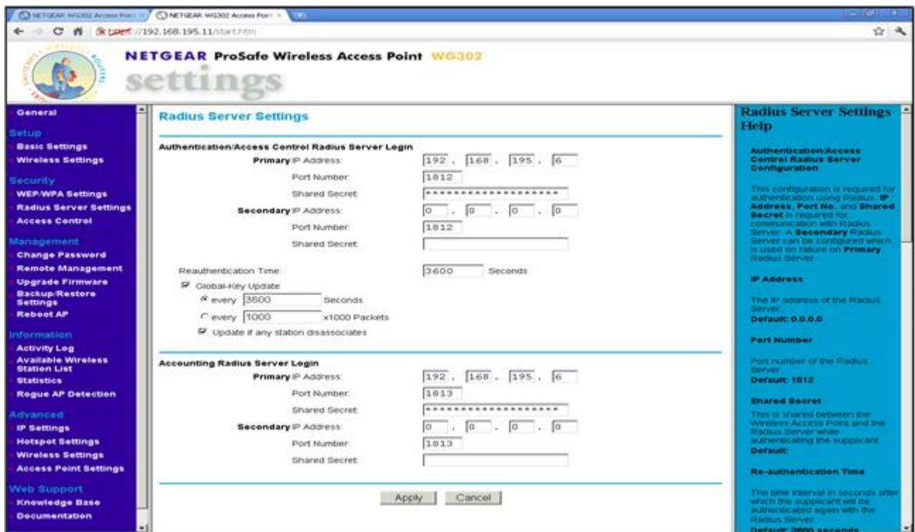
Figura 36. Configuración de los parámetros de seguridad del AP-2 (parámetros correspondientes al servidor RADIUS).
