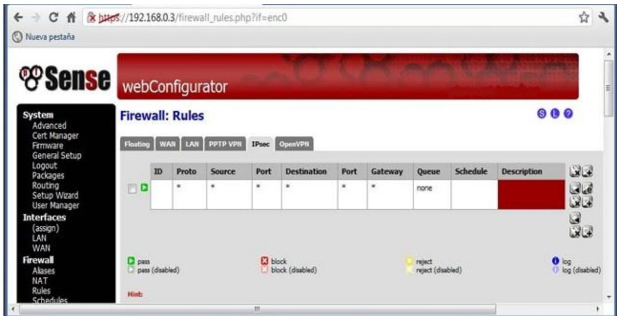
Figura 46. Regla en el Firewall de PfSense para la VPN IPsec (interfaz IPsec).
