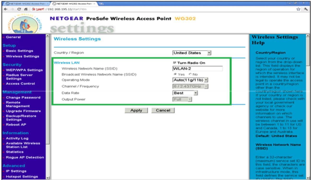
Figura 33. Configuración de los parámetros Wireless del AP-2 (nombre de la red, modo de operación, canal/frecuencia, razón de datos).
