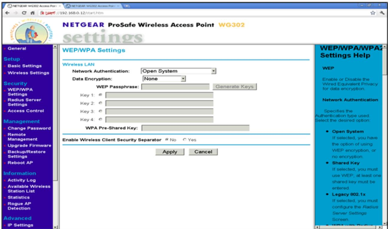
Figura 34. Configuración de los parámetros de seguridad del AP-1 (autenticación de red, cifrado de datos).
