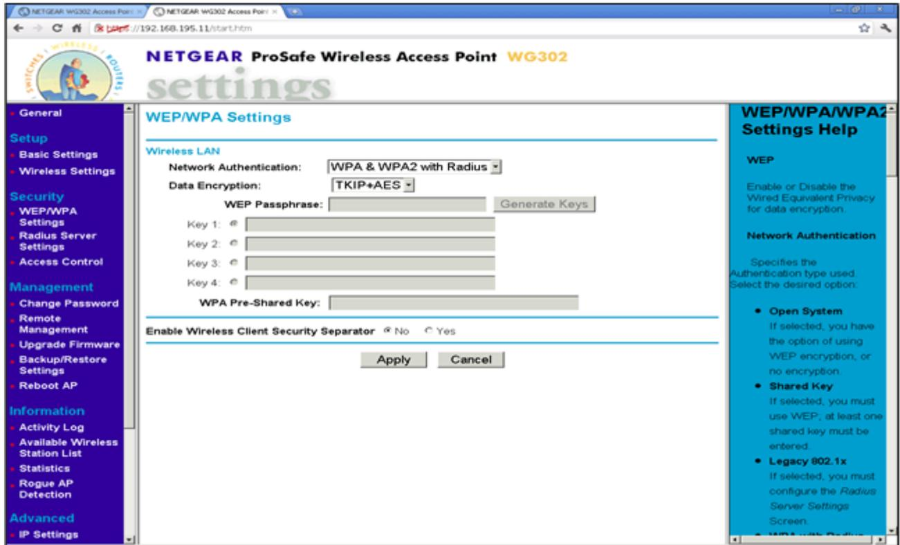
Figura 35. Configuración de los parámetros de seguridad del AP-2 (autenticación de red, cifrado de datos).
