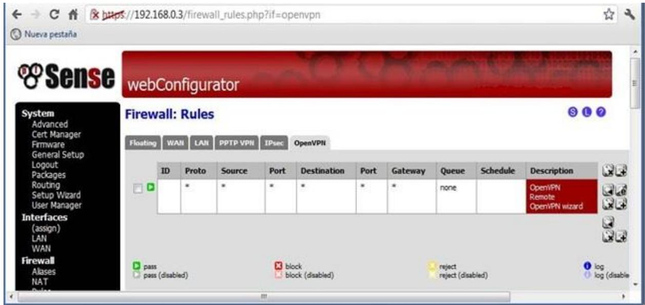
Figura 51. Regla en el Firewall para la OpenVPN.
