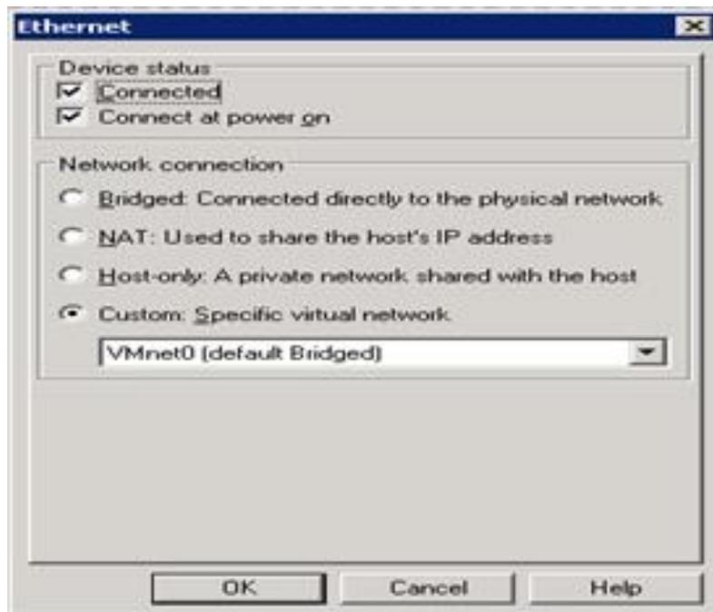
Figura 14. Interfaz Ethernet (LAN) se puentea con la VMnet0.
