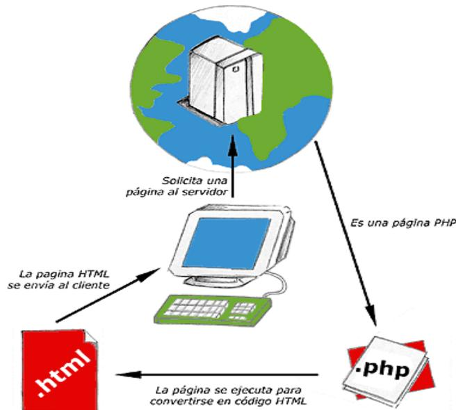
Figura 3: Esquema del funcionamiento de las páginas PHP
