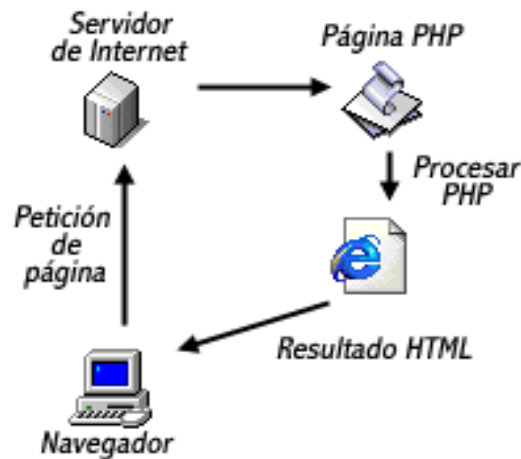
Figura 2 Lógica de una petición en PHP
