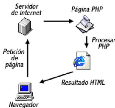
Figura 3 Estructura funcional de PHP
