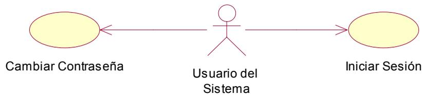
Fig. 14: Diagrama de casos de uso del sistema *Paquete de Seguridad y Utilidades*
