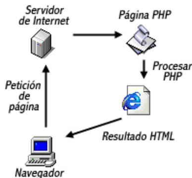
Figura 3. Estructura funcional de PHP.
