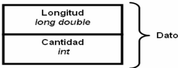
Ilustración 16. -Estructura del archivo. Dato de plan de corte-
