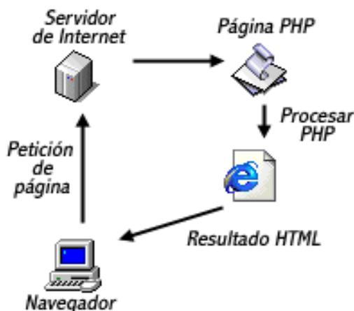
Figura 1. Esquema de representación del PHP [13]
