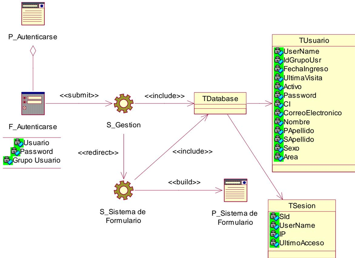
Figura 1. Diagrama de clases Web de autenticación
