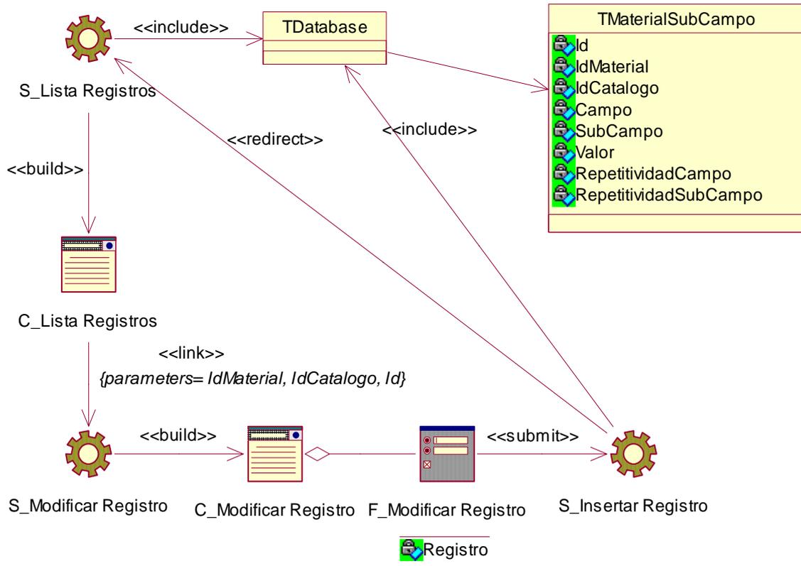
Figura 11. Diagrama de clases Web de modificar registro
