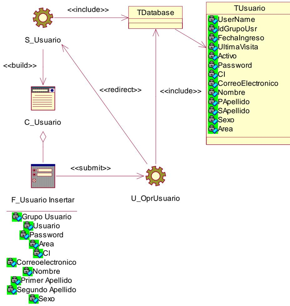
Figura 7. Diagrama de clases Web de insertar usuario
