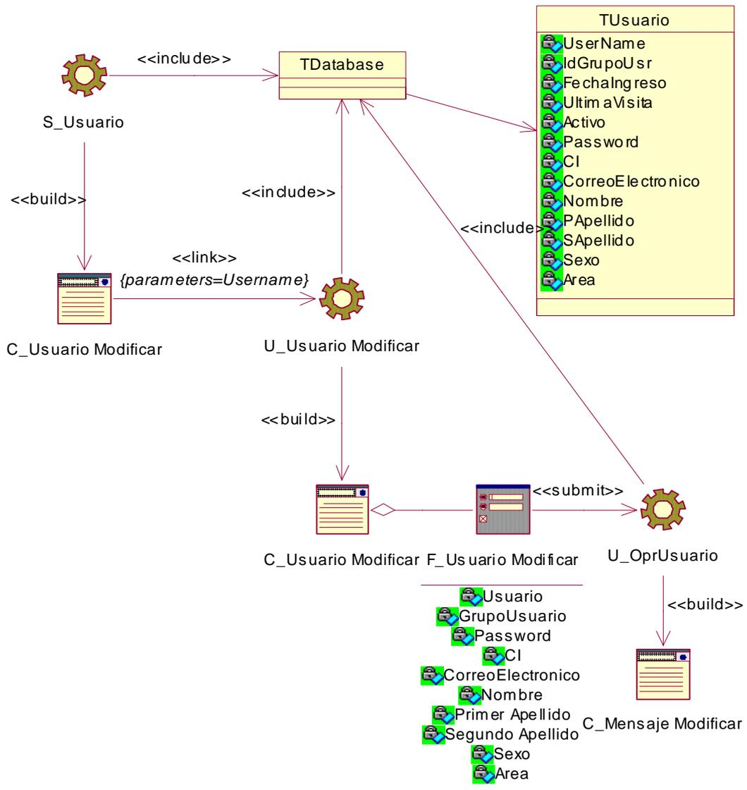
Figura 12. Diagrama de clases Web de modificar usuario
