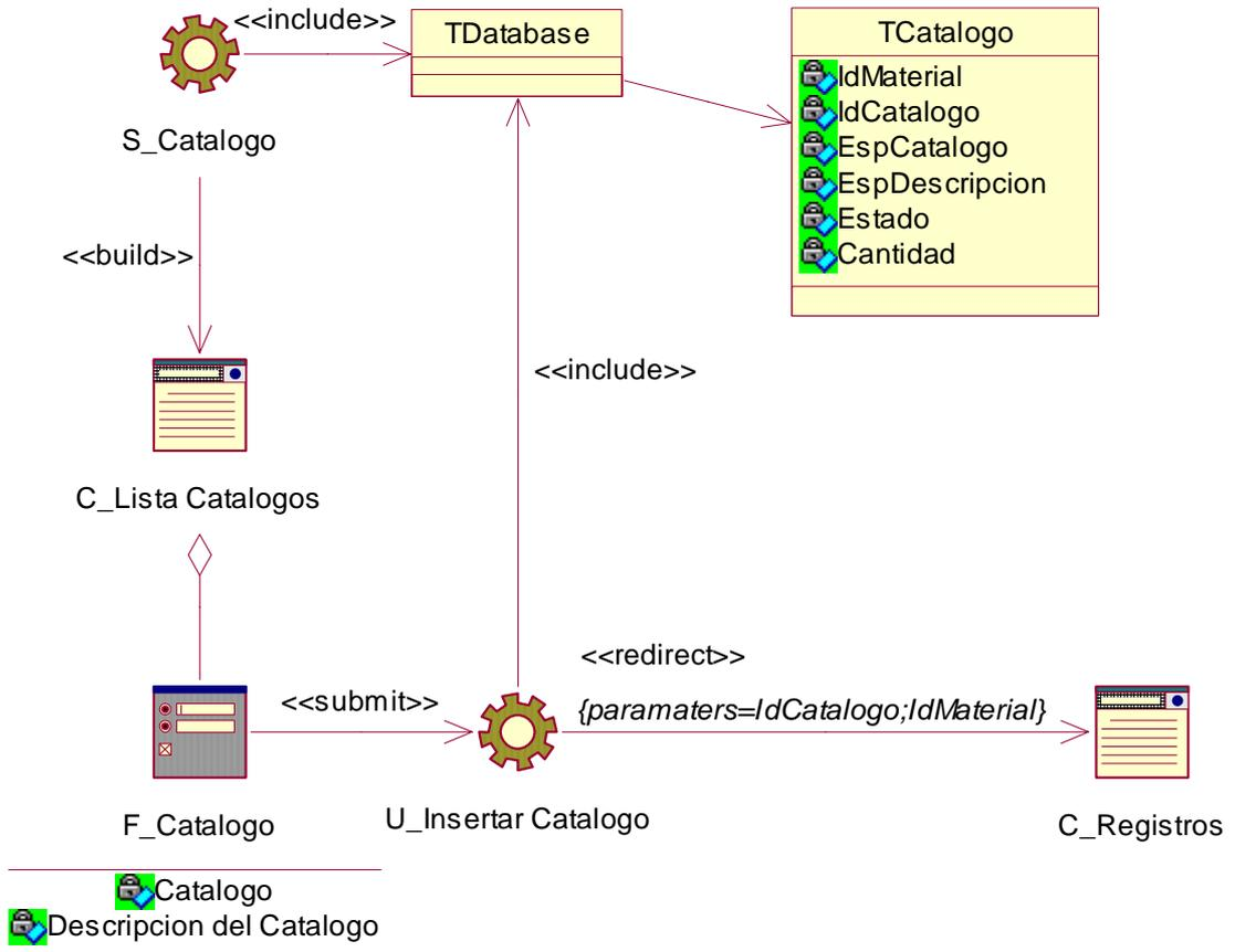
Figura 2. Diagrama de clases Web de insertar catalogo
