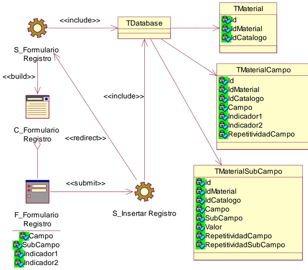
Figura 5. Diagrama de clases Web de insertar registro
