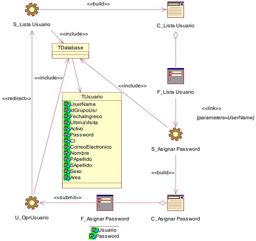
Figura 21. Diagrama de clases Web de asignar password
