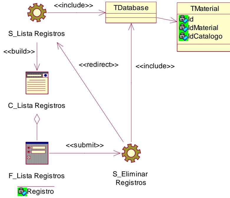
Figura 15. Diagrama de clases Web de eliminar registros
