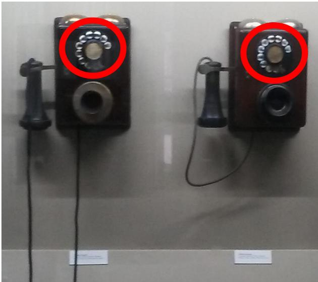
Fig. 10.1 Teléfonos automáticos de Pared
