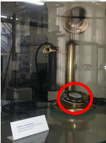
Fig. 10.2: Teléfono automático de mesa.
