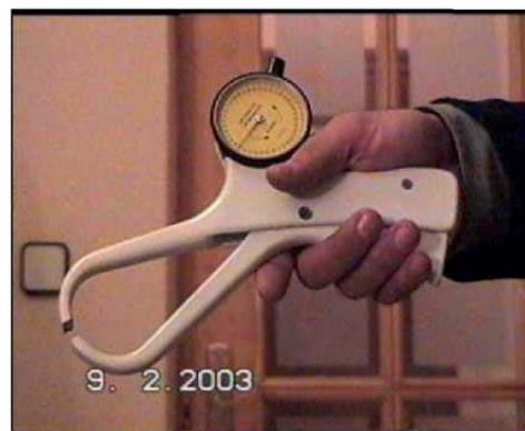
Figura 4. Plicómetro Holtain.
