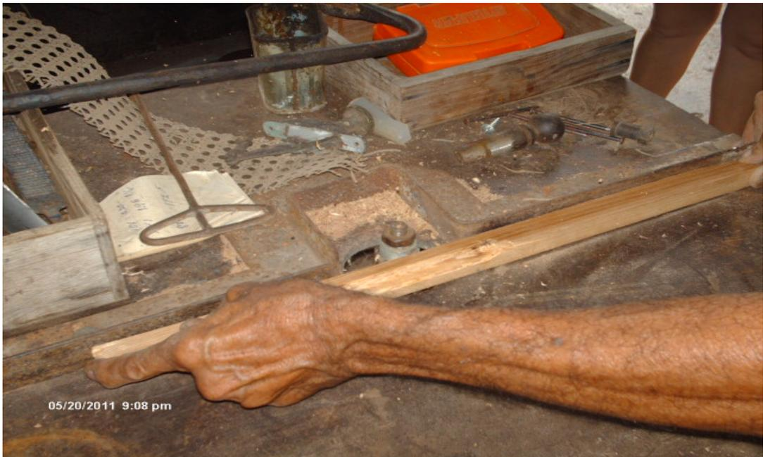
**Fresadora vertical (Trompo o Tupí)**
