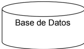
Representa a una Base de datos y se suele utilizar para la introducción o registro de datos en una base de datos (habitualmente informática)
