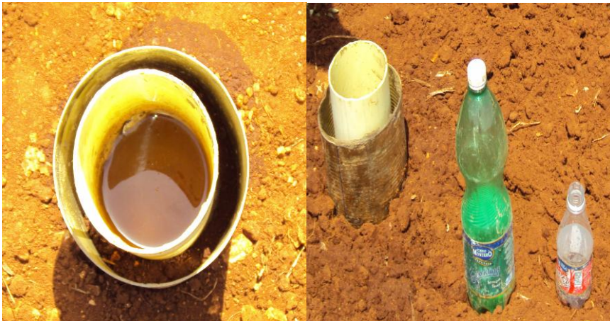
Figura 5. Pruebas de infiltración del agua en la Finca.
