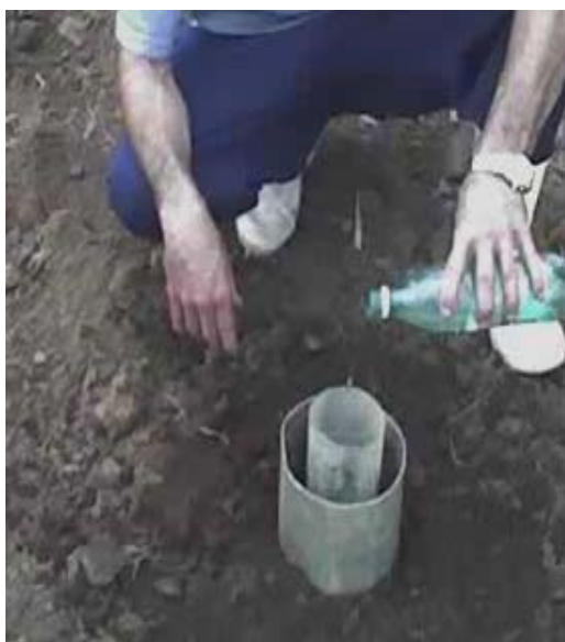
Foto 4. Medición de infiltración de agua.
