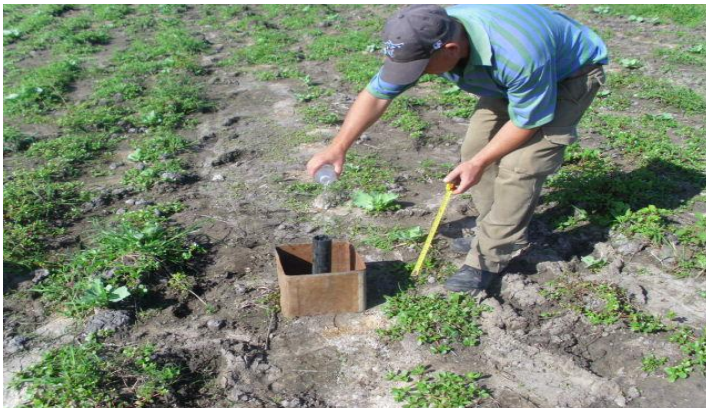
Figura 14. Infiltración del agua
