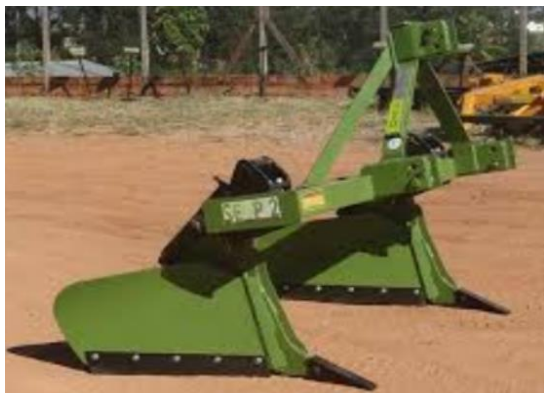
Figura 3. Surcador doble para tecnología de siembra Tradicional.
