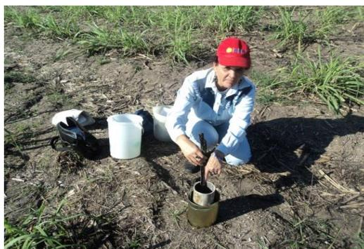
**Fig. 17 Medición de Infiltración del agua Imagen en la UBPC "La Josefa".**
