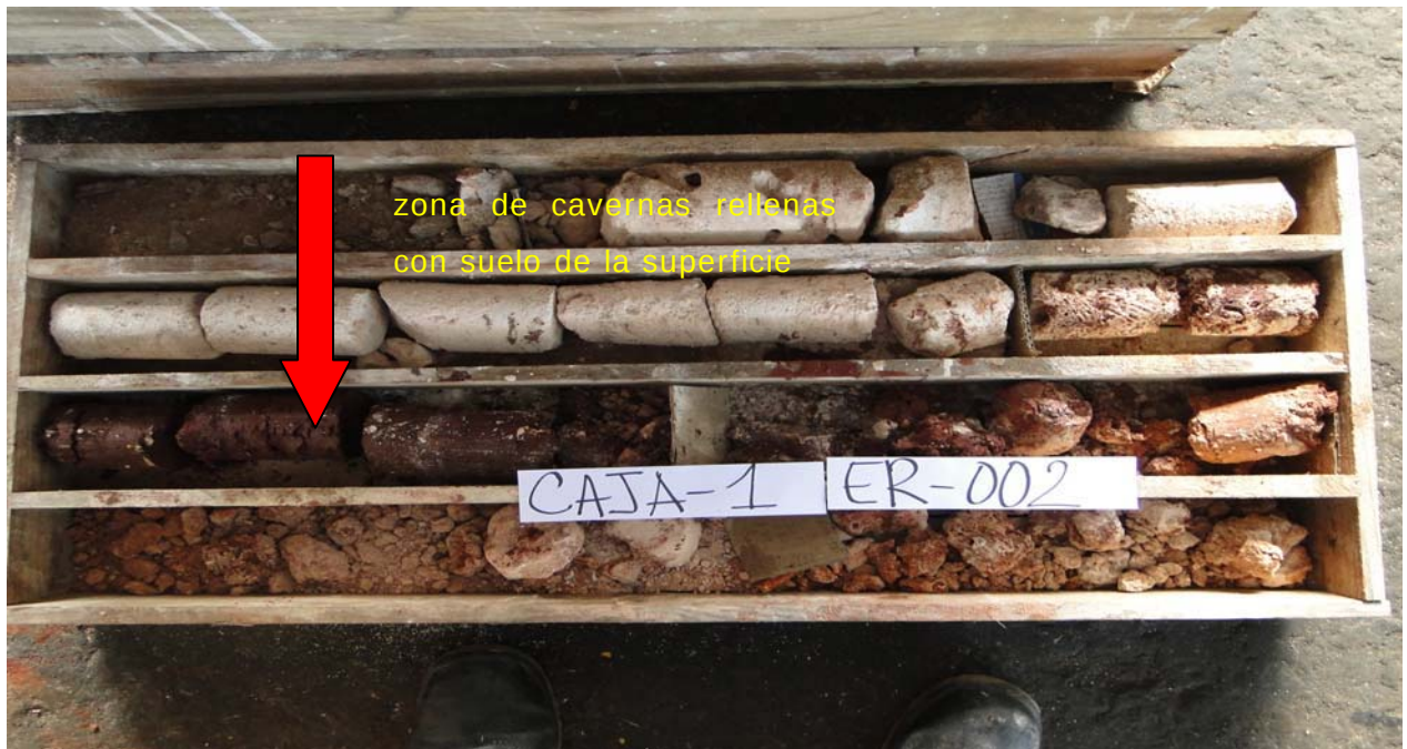
Fotografía 1(Autor L. Zamora). Presencia de una caverna a profundidad de dos metros rellenas por suelos de la superficie, se puede apreciar que la potencia de la caverna es de 50.cm, véase además como las rocas suprayacentes se encuentran carsificadas
