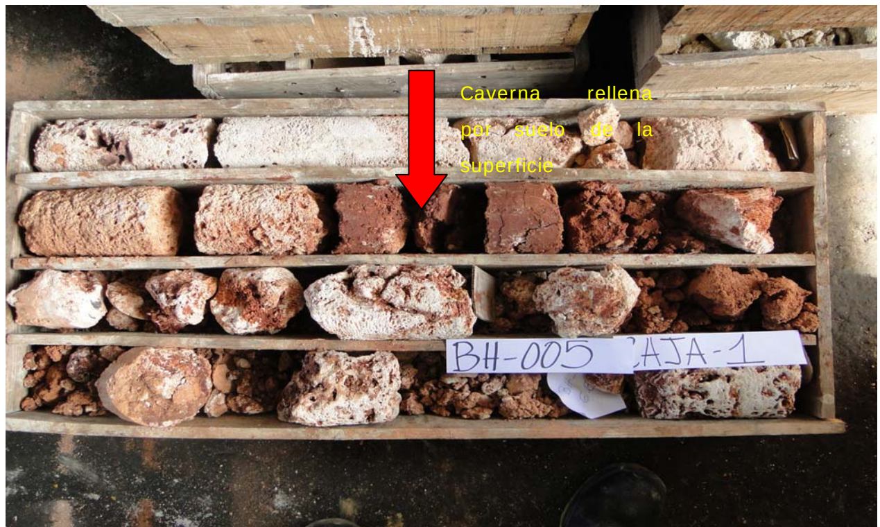
Fotografía 3 ( Autor L. Zamora). Caverna rellena por suelo de la superficie, a una profundidad de 1.5 m.
