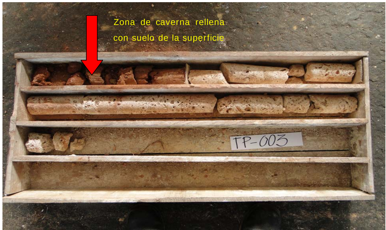
Fotografía 2 ( Autor L. Zamora). Presencia de caverna (0.5 m) rellena con suelo de la superficie a 6 m de profundidad, obsérvese como la roca subyacente acusa la acción cársica
