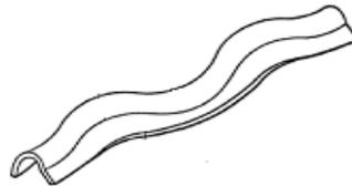
**Figura 1.12. Plancha conformada utilizada en la fabricación del rotor (Gunther, 1981).**
