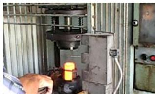
**Figura 3.15. Colocación del tubo en el molde.**
