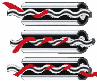
**Figura 1.2. Principio de funcionamiento de una bomba de cavidad progresiva (Hirschfeldt., 2008a).**
