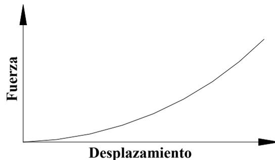
**Fig. 1.5 Características de un sistema de amortiguación mediante muelles o topes de gomas**
