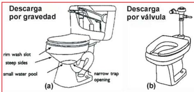
Fig. 51. Tipos de tazas sanitarias: a) descarga por gravedad y b) descarga por válvula.
