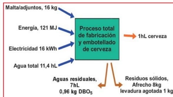
Fig. 47. Entradas y salidas totales de materias primas, energía y agua en una cervecería.
