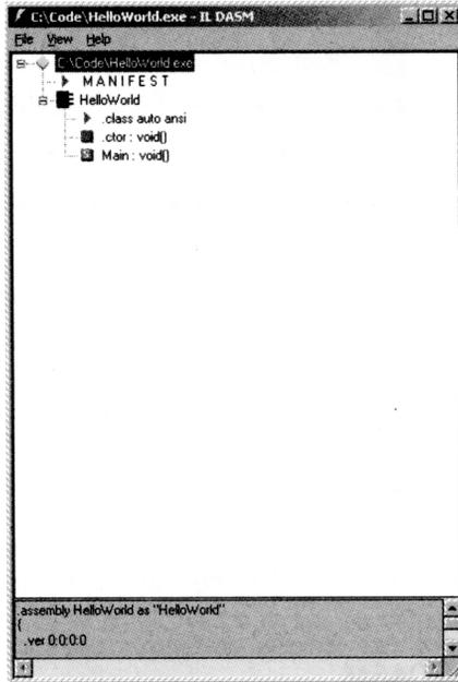
**Figura 3.4.** ILDASM le deja investigar a fondo el contenido del manifiesto y los codigos de operación IL que componen su aplicación .NET.
