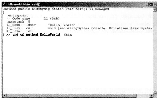
**Figura 3.6.** Buscar un rnetodo en el MSIL generado, abrir el binario en ILDASM y hacer doble clic en el rnetodo.
