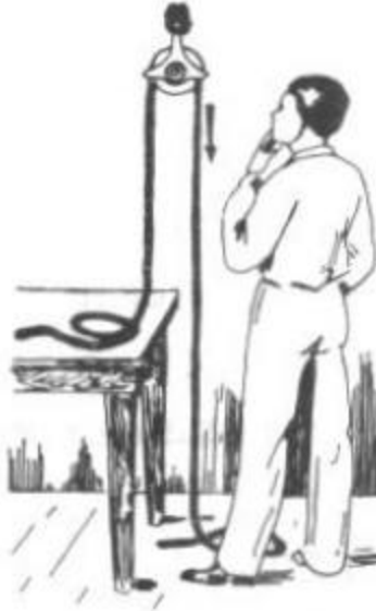
Explicación evidente de cómo funciona el sifón.
