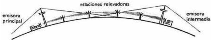
*Figura 40.6 El enlace "casi óptico" de las ondas de la televisión hace necesario instalar estaciones relevadoras y emisoras intermedias*
