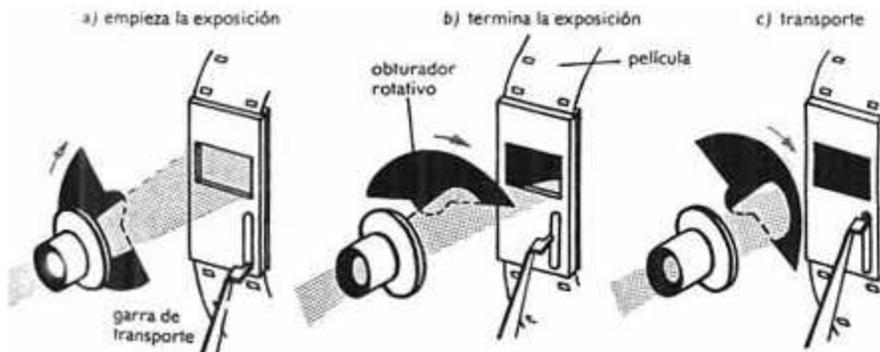
Figura 4.4 Trabajo combinado de los sistemas de exposición y transporte de película
