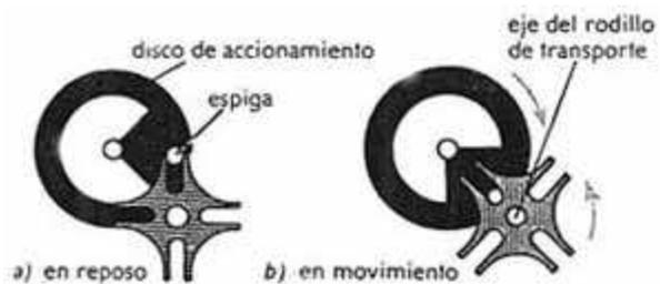
Figura 33.3 Mecanismo de transporte mediante cruz de Malta
