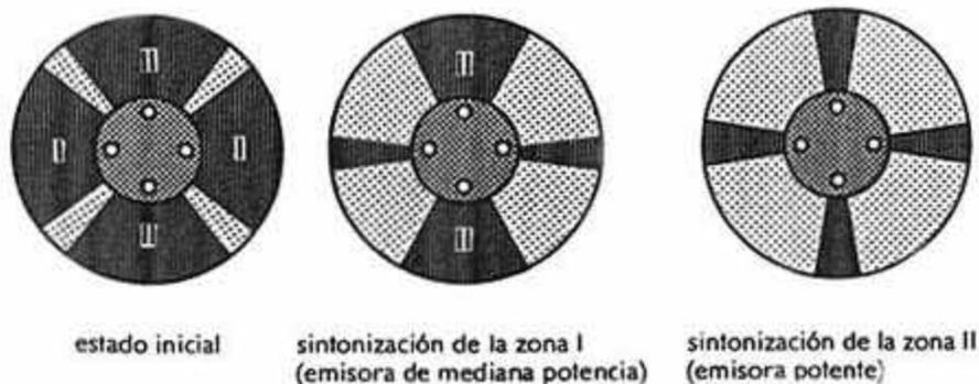
Figura 28.2 Imágenes de una válvula de doble sintonización
