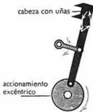
Figura 33.2 Mecanismo de transporte con garra de arrastre
