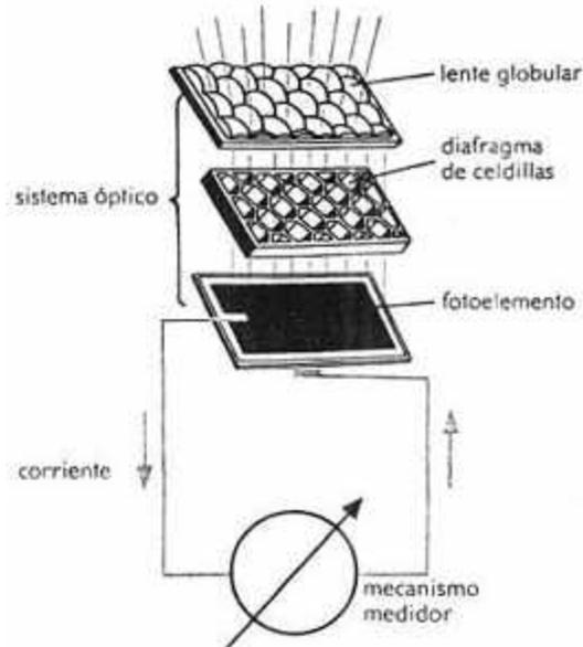
Figura 15.1 Disposición esquemática de un fotómetro eléctrico
