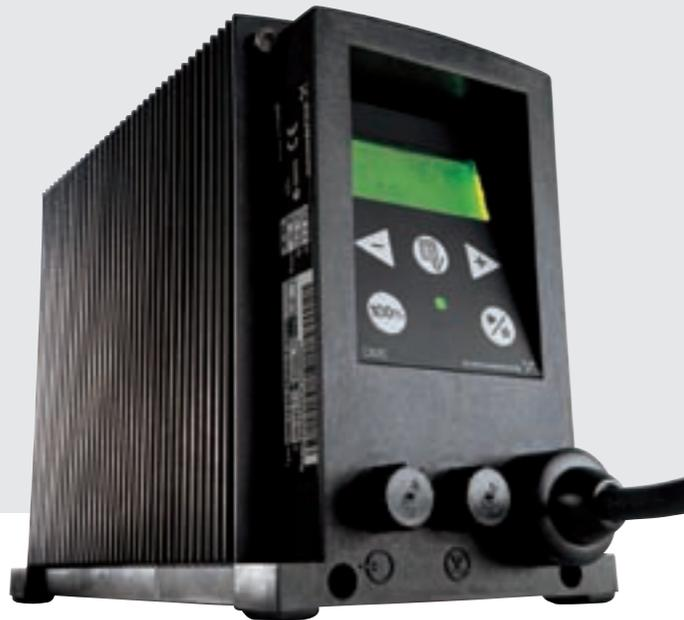
La gama de dosificadoras Grundfos consta de dos variantes de motor. La serie DME se suministra con un motor de velocidad variable. Las series DMS utilizan motores síncronos que funcionan a una velocidad constante, deteniéndose solamente entre los ciclos.
